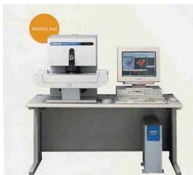
ภาพประกอบ 16 วิธีเอ็กซ์เรย์ฟลูออเรสเซนซ์ (XRF)
