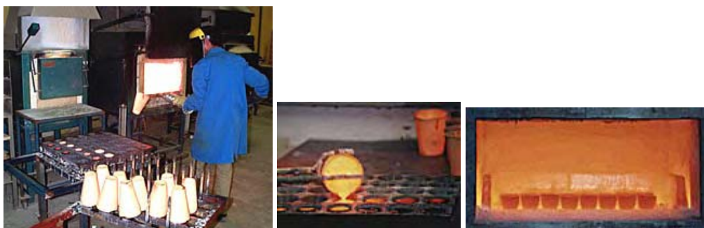
ภาพประกอบ 14 วิธีการตรวจวิเคราะห์ (Fire assay or cupellation)
