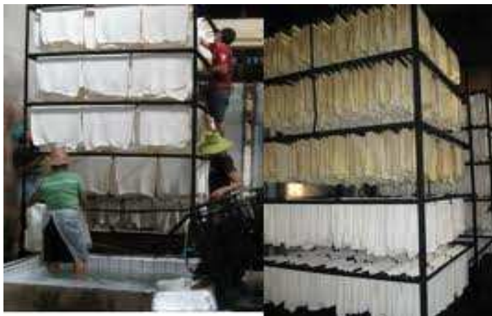
ภาพประกอบ 15 ชั้นตอนการเตรียมแผ่นยางก่อนเข้ารมควัน
